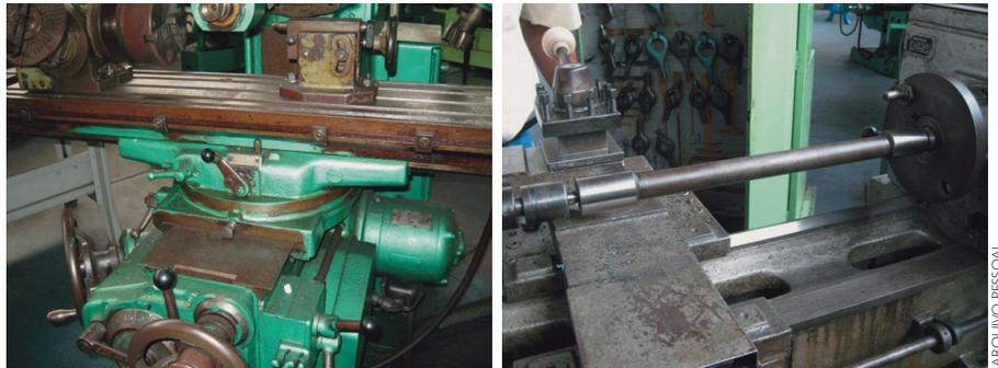
Esses sistemas mecânicos são formados por diversos componentes que se relacionam por meio de guias de deslizamento, guias de rolamento, engrenagens, polias, eixos, fusos, mancais de deslizamento, mancais de rolamento, correias, cabos, molas etc.
