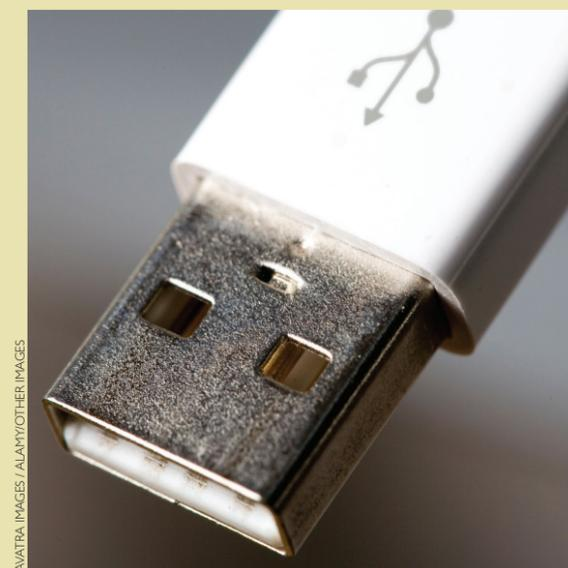
**Figura 52 -** Modelo de conector A.
