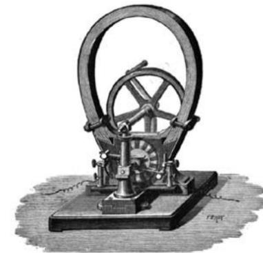
Como se observa na figura 4.6, o grande anel na parte superior da máquina de Gramme é um ímã permanente. Na parte inferior, há um ímã e, entre os polos do ímã, um disco preso a uma manivela. Próximo a essa manivela, encontram-se bobinas constituídas de fios de cobre com espiras em volta de um núcleo de ferro de formato circular, conforme ilustra a figura 4.7.
