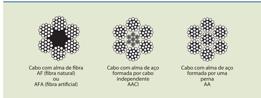
Figura 3.20 Exemplos de almas de cabos de aço.
