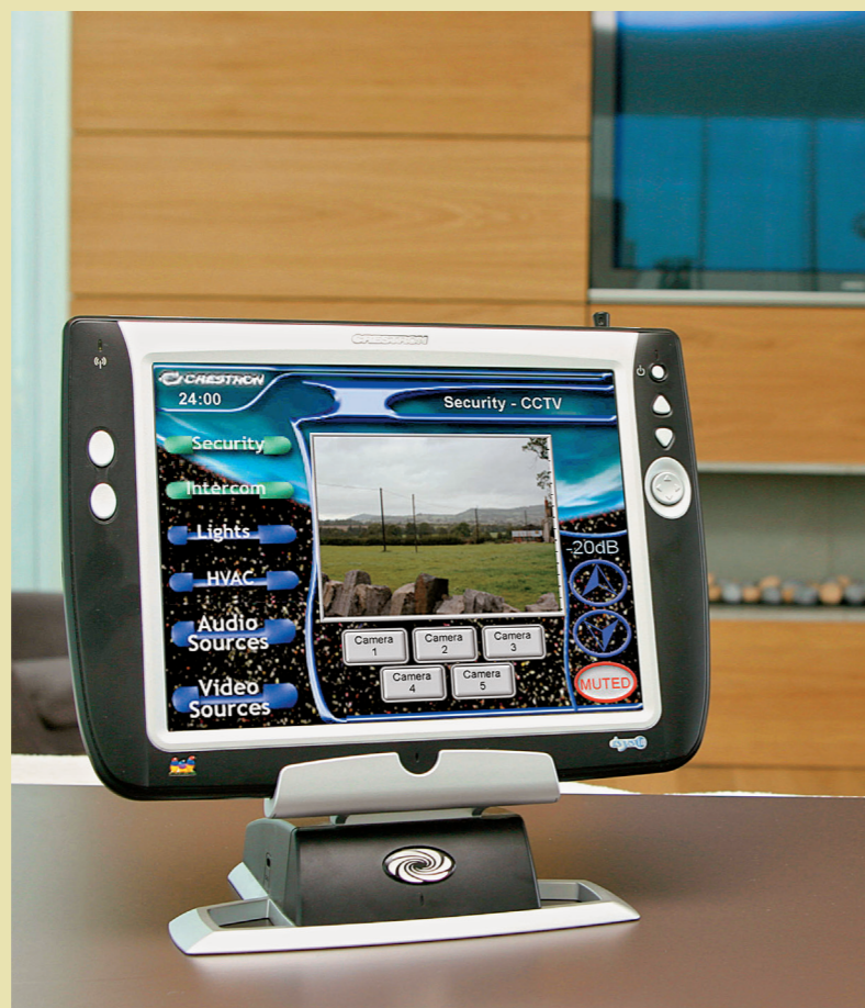
Figura 90 Controle principal de uma casa controlada por computador.
